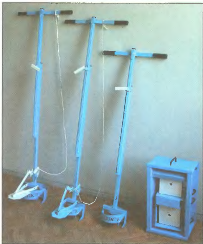
Буры фундаментные ТИСЭ-Ф (25см) и ТИСЭ-2Ф (20см); бур садовый ТИСЭ-С; опалубка ТИСЭ-2
