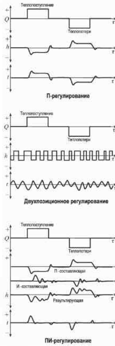
Рис. 4.4. Регулирование температуры воздуха системой отопления
