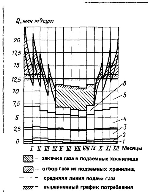
Рис. 5.3. Годовой график потребления газа промышленного узла 1 — коммунально бытовое потребление, 2 — плавильные печи, 3 — промышленные печи,
