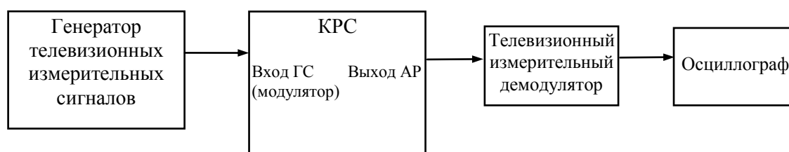
Рисунок 7.2 - Структурная схема измерения импульсной характеристики канала распределения (К – фактора)
