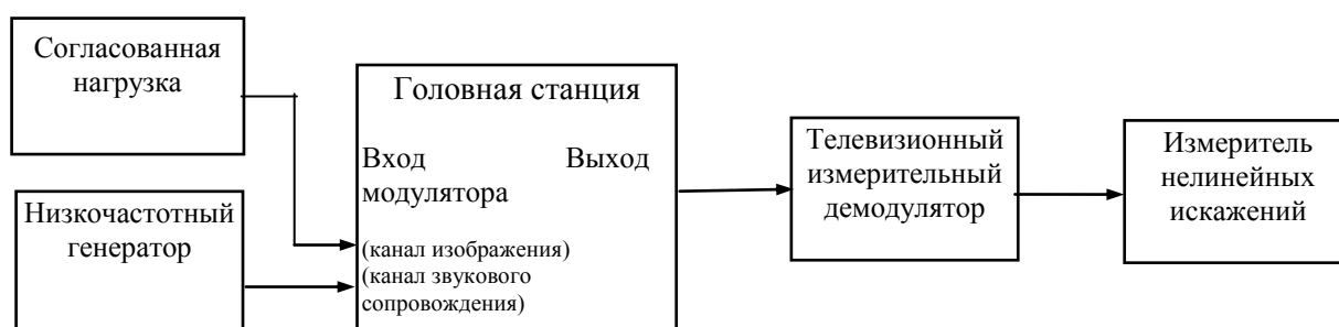
Рисунок 7.26 - Структурная схема для измерения нелинейных искажений сигнала звукового сопровождения
