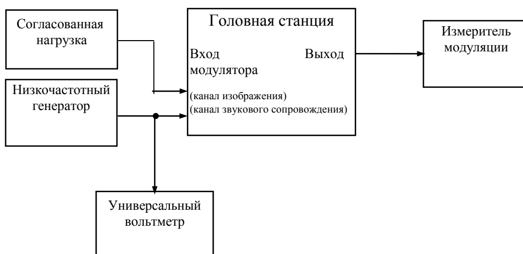
Рисунок 7.25 Структурная схема для определения уровня мощности сигнала звукового сопровождения на входе модулятора и измерения девиации несущей частоты радиосигнала звукового сопровождения
