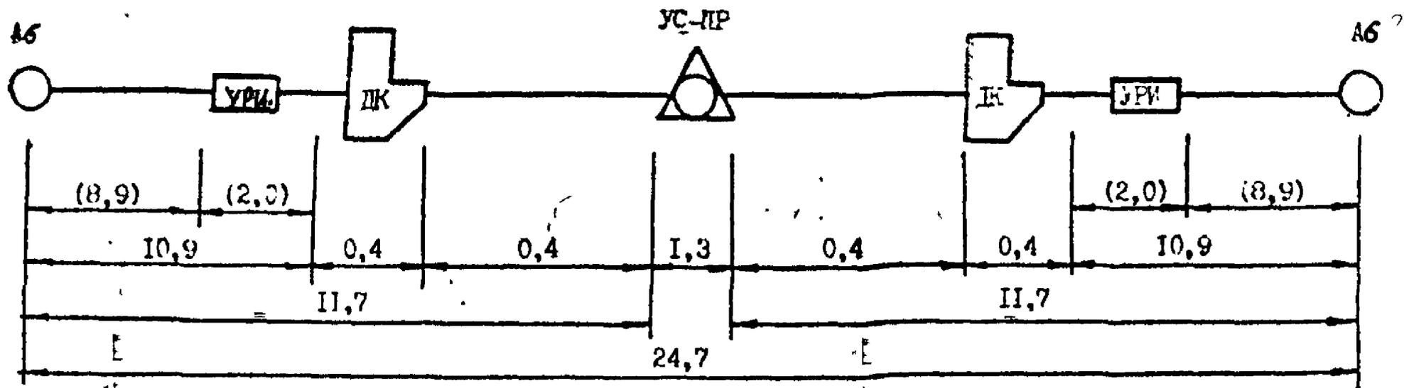
Рис. 6.4. Распределение затухания, дБ, на телефонной сети предприятия (Основной вариант)
