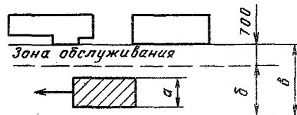
Рис. 3. Односторонний проезд при одной зоне обслуживания оборудования
