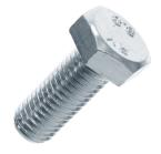
Болт снабжён головкой и резьбой по стержню. Она нужна, чтобы навинтить гайку. Болтовое соединение предполагает, что в двух деталях высверливаются сквозные отверстия, в которые вставляется болт, и с обратной стороны конструкция затягивается гайкой.
