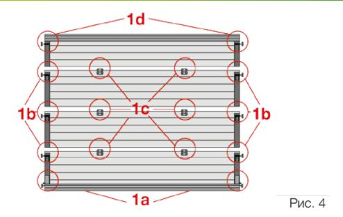
• Собрать полотно ворот, закрепить на панелях петли 1с, боковые опоры 1b, верхние опоры 1d и нижние угловые кронштейны 1a
