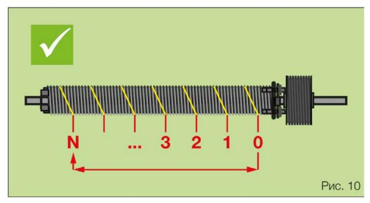
• Сбалансировать полотно ворот взведением пружины на количество оборотов согласно инструкции, прилагаемой к воротам.
