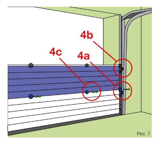
• Установить полотно в направляющие. Панели фиксируются на направляющие с помощью роликов 4b и 4a. Панели между собой соединяются петлями 2c и боковыми опорами 1b (см. рис. 4)
