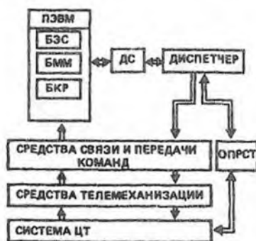
Структурная схема автоматизированной системы диспетчерского управления централизованным теплоснабжением
