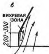
Конструктивная схема вытяжного зонта (а) и конструкции "юбки с кларманом", обеспечивающей размещение в ней вихревой зоны (б), и "юбки обыкновенной" (в)
