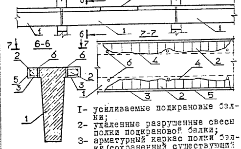
ВОССТАНОВЛЕНИЕ ОБЕТОНИРОВАНИЕМ ПО АДГЕЗИОННОЙ ПРОМАЗКЕ
