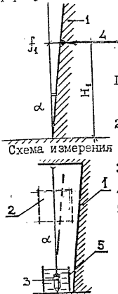
ИЗМЕРЕНИЕ ПРОГИБОВ И ВЫПУЧЕНИЙ ОТВЕСОМ С ЛИНЕЙКОЙ
