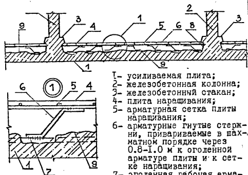
НАРАЩИВАНИЕ ПЛИТЫ СВЕРХУ ПРИ НЕДОСТАТОЧНОМ СЦЕПЛЕНИИ ПОВЕРХНОСТИ
