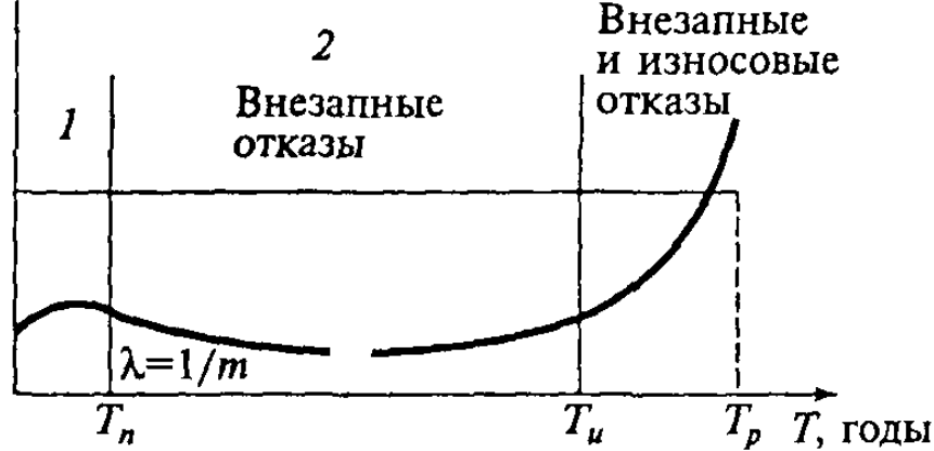
Р и с. 1.2. Интенсивность отказов элементов как функция времени эксплуатации:
