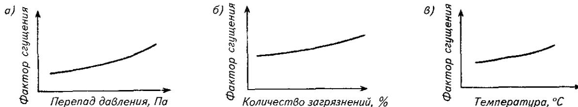
Рис. 1.47. Характер зависимости фактора сгушения от перепада давления (а), количества загрязнений (б) и температуры массы (в)
