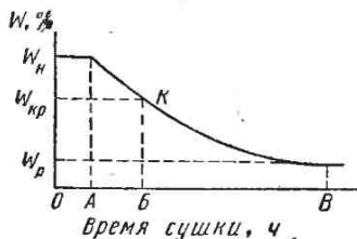
Рис. 9. График процесса сушки древесины
