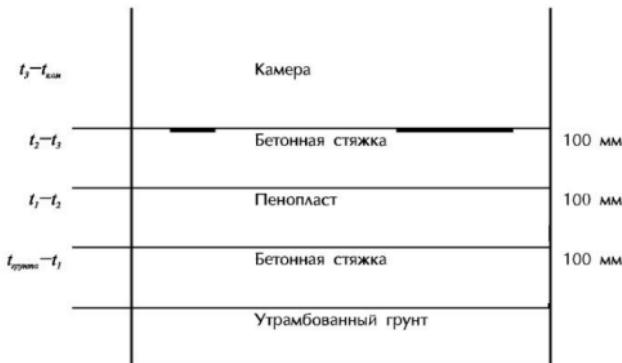
Рис. 2. Поперечный разрез пола камеры
