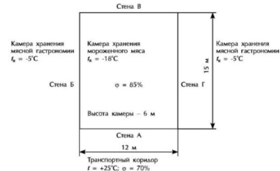
Рис.2.2. План камеры хранения замороженного мяса. Камера хранения мороженого мяса,  $t_k = -18^\circ\text{C}$
