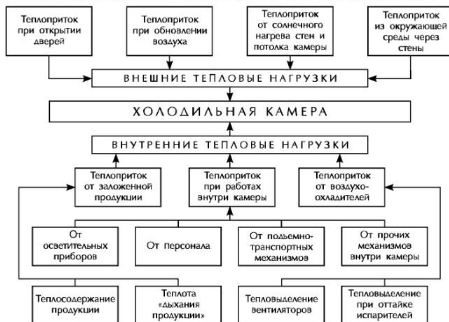
Рис. 2.1. Схема тепловых нагрузок на холодильную камеру
