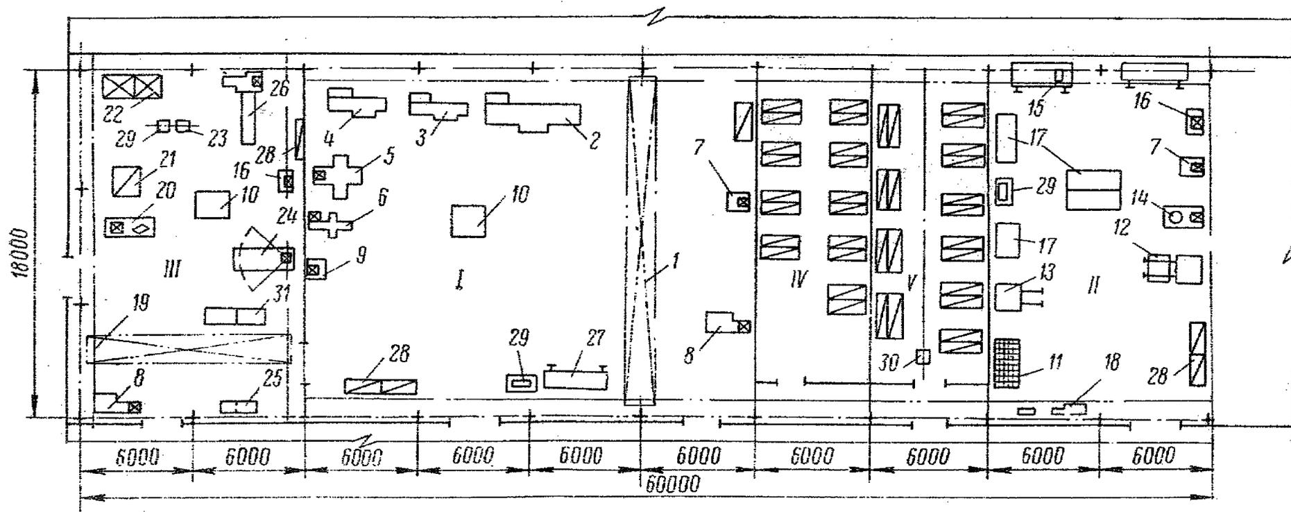
Рис. 2. Центральный ремонтный пункт (ЦРП) для фабрики производительностью свыше 9 млн. т в год. Общая площадь центрального ремонтного пункта—1080 м<sup>2</sup>.
