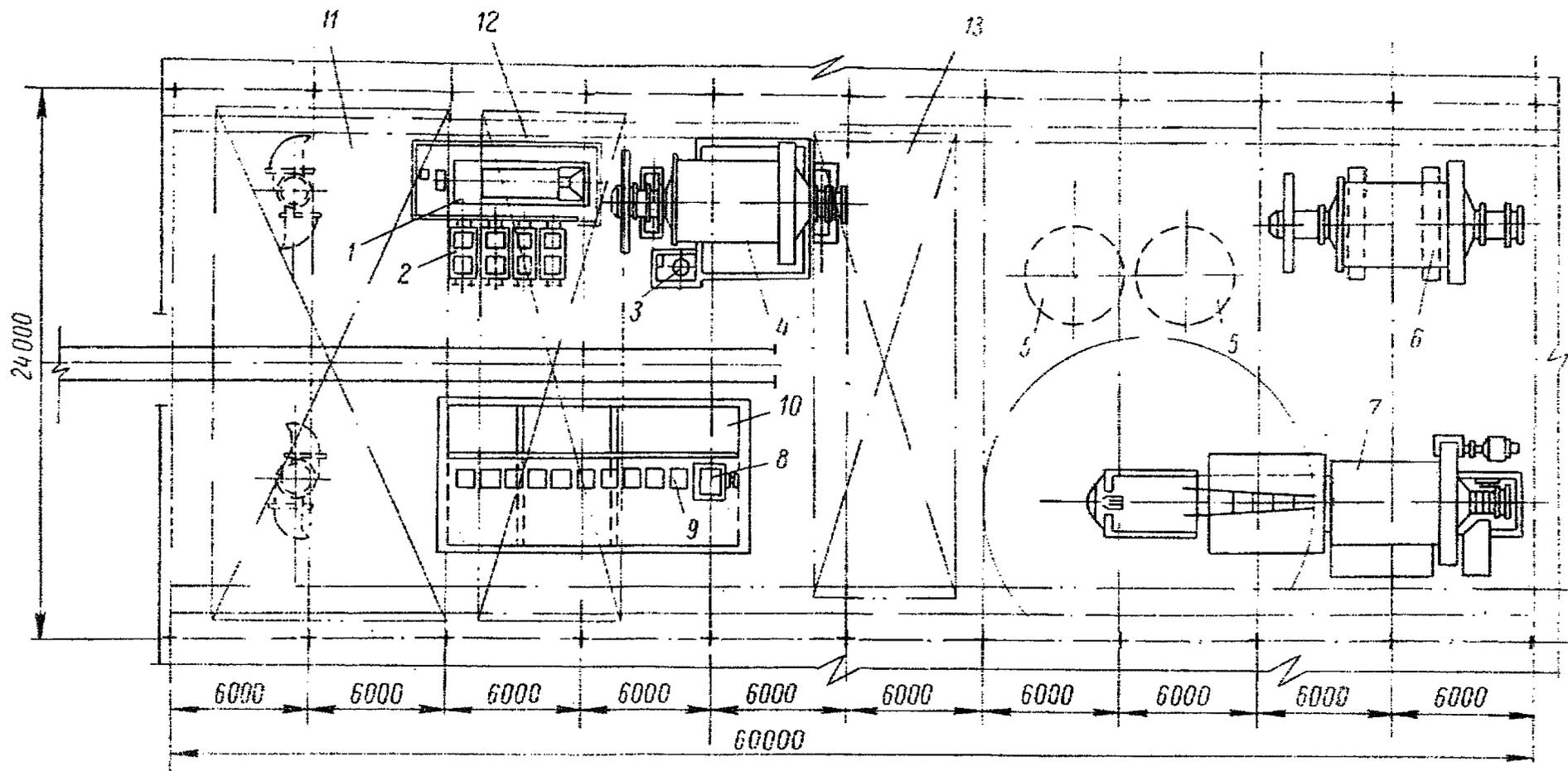
Рис. 9. Ремонтно-монтажная площадка пролета измельчения с двумя типами мельниц: шаровых 3600 x 5000 мм и стержневых 3600 x 5000 мм с перефутеровкой их на ремонтно-монтажной площадке. Общая площадь ремонтно-монтажной площадки—1440 м<sup>2</sup>; площадь, обслуживаемая краном,—814 м<sup>2</sup>, общее количество мельниц— 18 шт.:
