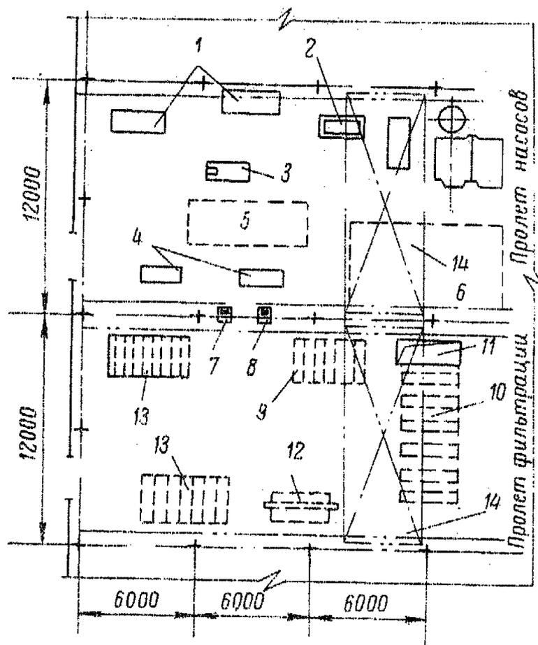
Рис. 13. Ремонтно-монтажные площадки пролета насосов и пролета вакуум-фильтров. Площадь ремонтно-монтажной площадки насосов—184 м<sup>2</sup>; площадь, обслуживаемая краном,—120 м<sup>2</sup>; площадь ремонтно-монтажной площадки вакуум-фильтров—216 м<sup>2</sup>; площадь, обслуживаемая краном,—144 м<sup>2</sup>.
