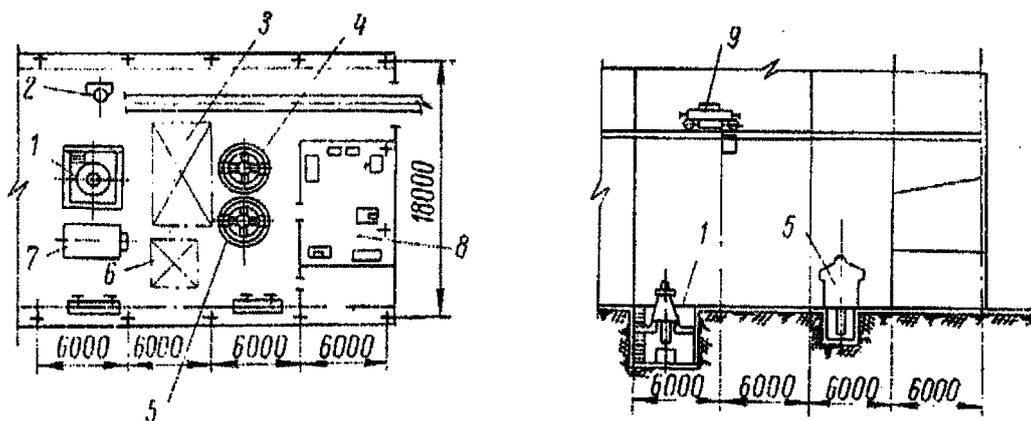
Рис. 5. Ремонтно-монтажная площадка корпуса крупного дробления со щековой дробилкой ШКД 1500 x 2100 и конусной дробилкой КРД-700. Общая площадь ремонтно-монтажной площадки  $432 \text{ м}^2$ ; площадь, обслуживаемая краном,  $255 \text{ м}^2$ .
