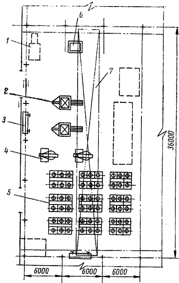
Рис. 11. Ремонтно-монтажная площадка пролета флотации. Общая площадь ремонтно-монтажной площадки— $648 \text{ м}^2$ , площадь, обслуживаемая краном— $544 \text{ м}^2$ :
