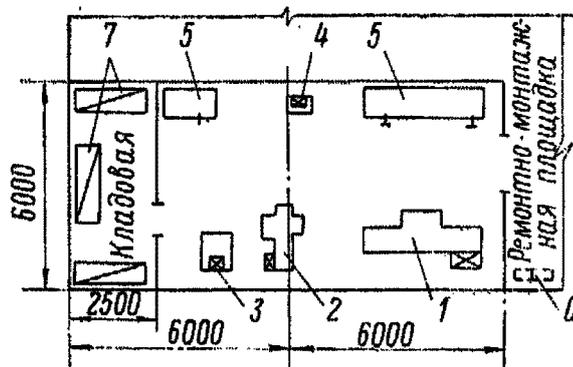
Рис. 3. Ремонтный пункт I-ой категории. Общая площадь ремонтного пункта 72 м<sup>2</sup>:
