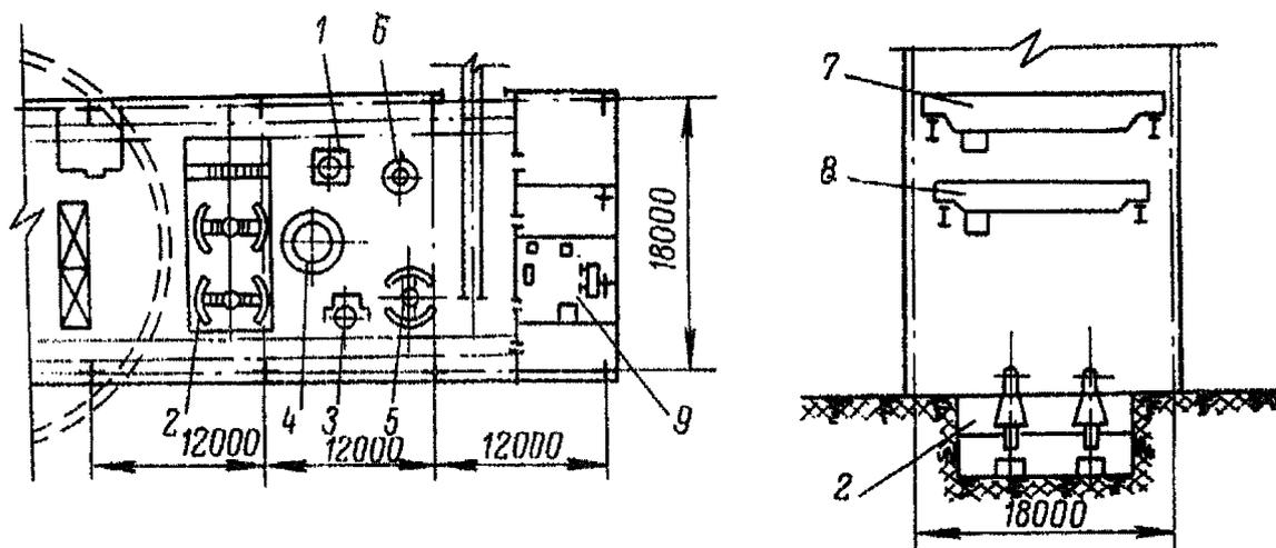
Рис. 6. Ремонтно-монтажная площадка корпуса крупного дробления с дробилками ККД-1500/180. Общая площадь ремонтно-монтажной площадки  $540\text{ м}^2$ ; площадь, обслуживаемая краном, —  $360\text{ м}^2$ .
