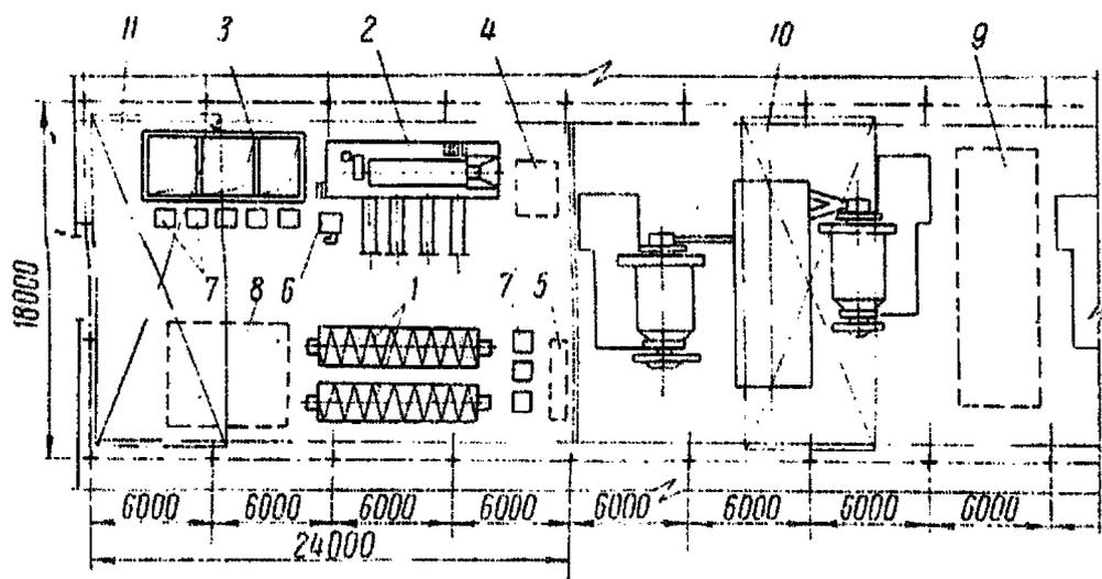
Рис. 10. Ремонтно-монтажная площадка пролета измельчения с двумя типами мельниц: шаровой 2700 x 3600 мм и стержневой 2700 x 3600 мм, с перефутеровкой мельниц на месте. Общая площадь ремонтно-монтажной площадки—432 м<sup>2</sup>, площадь, обслуживаемая краном,—300 м<sup>2</sup>. Общее количество мельниц—6 шт.:
