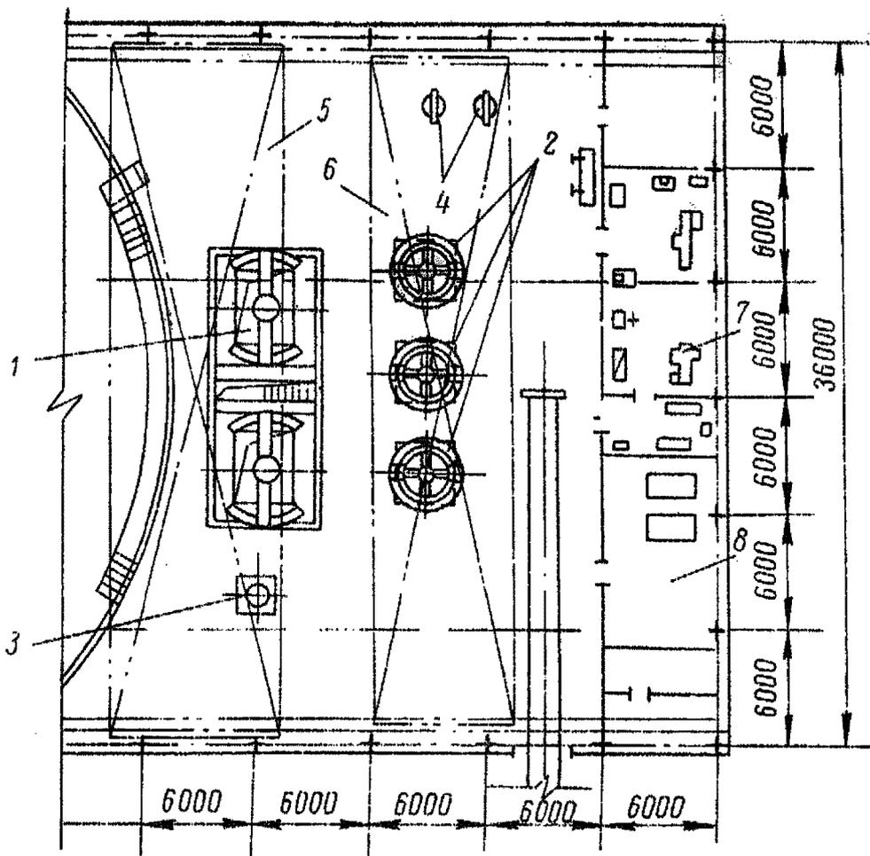
Рис. 7. Ремонтно-монтажная площадка корпуса двухстадиального крупного дробления с дробилками ККД-1500/180 и КРД-900/100. Общая площадь ремонтно-монтажной площадки—1080 м<sup>2</sup>, площадь, обслуживаемая краном,—790 м<sup>2</sup>.
