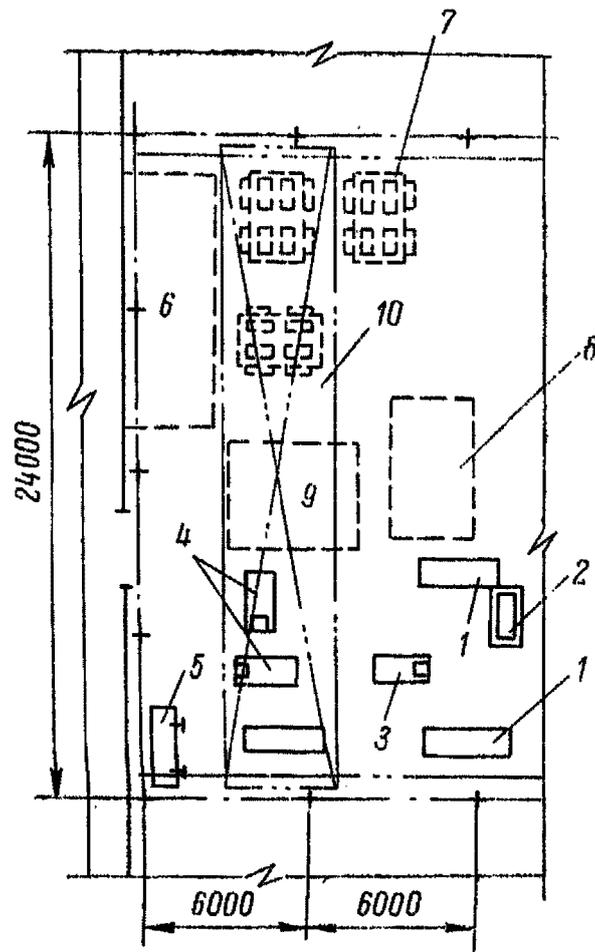
Рис. 12 Ремонтно-монтажная площадка пролета магнитных сепараторов и насосов. Площадь ремонтно-монтажной площадки—288 м<sup>2</sup>, площадь, обслуживаемая краном,—160 м<sup>2</sup>.
