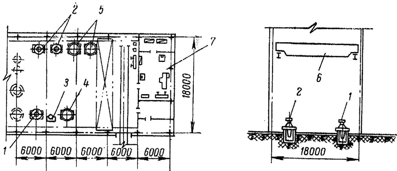
Рис. 8. Ремонтно-монтажная площадка корпуса среднего и мелкого дробления с дробилками КСД и КМД-2200. Общая площадь ремонтной площадки—432 м<sup>2</sup>, площадь, обслуживаемая краном,—246 м<sup>2</sup>.
