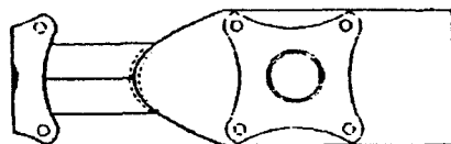
Рисунок 9.10 — Контроль сварного шва накладок нижнего пояса продольной балки рамы
