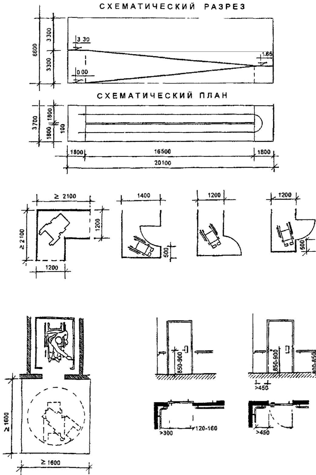
**РИС 3 6 ГАБАРИТНЫЕ СХЕМЫ ПАНДУСОВ, ПОВОРОТОВ В КОРИДОРАХ, ОТКРЫВАНИЯ ДВЕРЕЙ, ЛИФТОВЫХ ПЛОЩАДОК, ЛИФТОВЫХ ДВЕРЕЙ**
