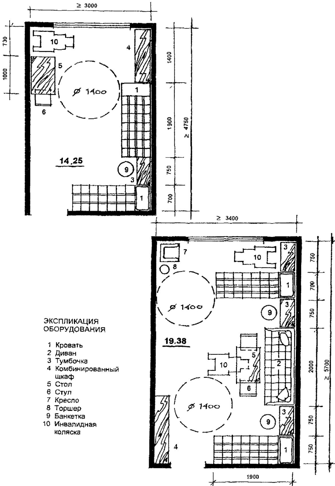
РИС 4 2 ПЛАНИРОВОЧНЫЕ СХЕМЫ СПАЛЬНЫХ КОМНАТ НА 2 И 3 МЕСТА
