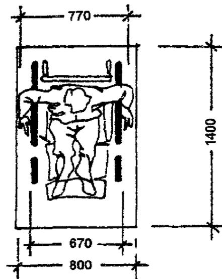
РИС 35 ГАБАРИТЫ КОЛЯСОК, ПРИМЕНЯЕМЫХ ДЛЯ ПЕРЕДВИЖЕНИЯ ИНВАЛИДОВ-ОПОРНИКОВ
