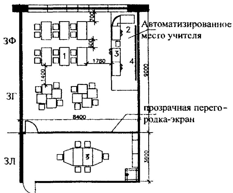
Рис. 7 Учебный кабинет специализированный с зоной лаборантской. В составе кабинета (КТ-II): Спецификация мебели и оборудования см. рис. 8
