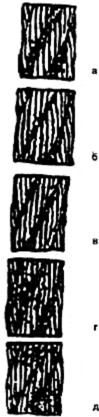
Рис. 5. Поверхностная коррозия проволок каната крестовой свивки: а - начальное окисление поверхности; б - общее окисление поверхности; в - заметное окисление; г - сильное окисление; д - интенсивная коррозия
