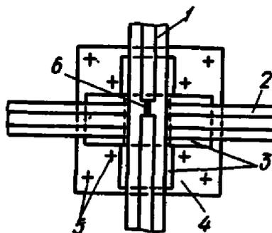
Рис. 8. Пересечение стапельных и откатных путей
