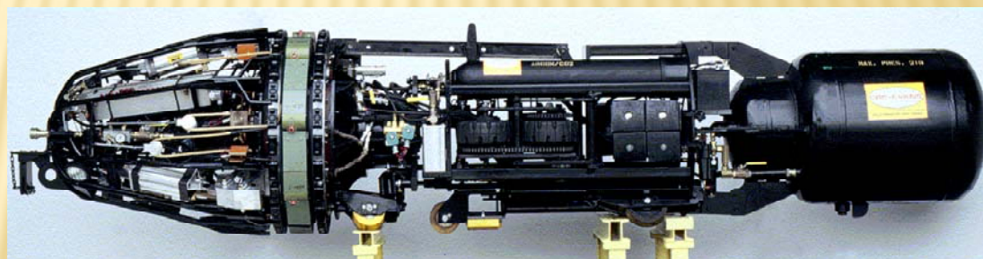
Внутренний пневматический центратор CRC Evans AW (совмещен с внутритрубным сварочным автоматом - IWM)
