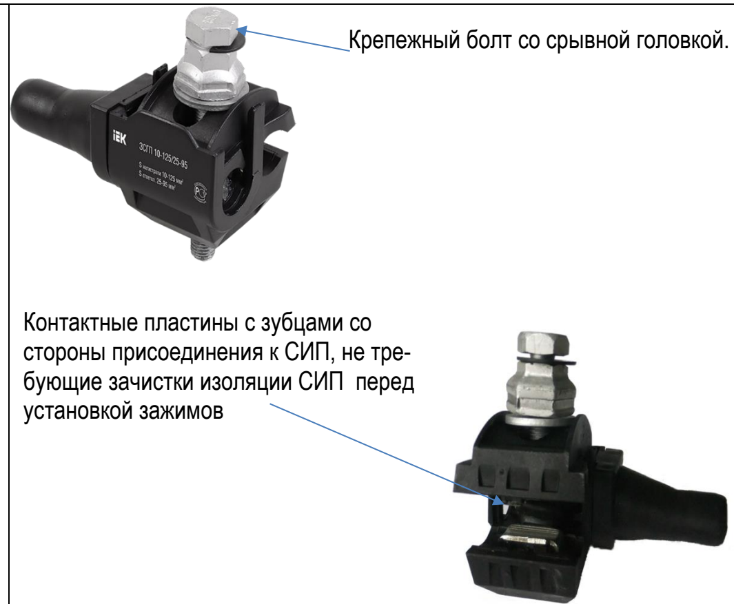
Рисунок 2 Односторонне прокалывающий зажим ЗСГП
