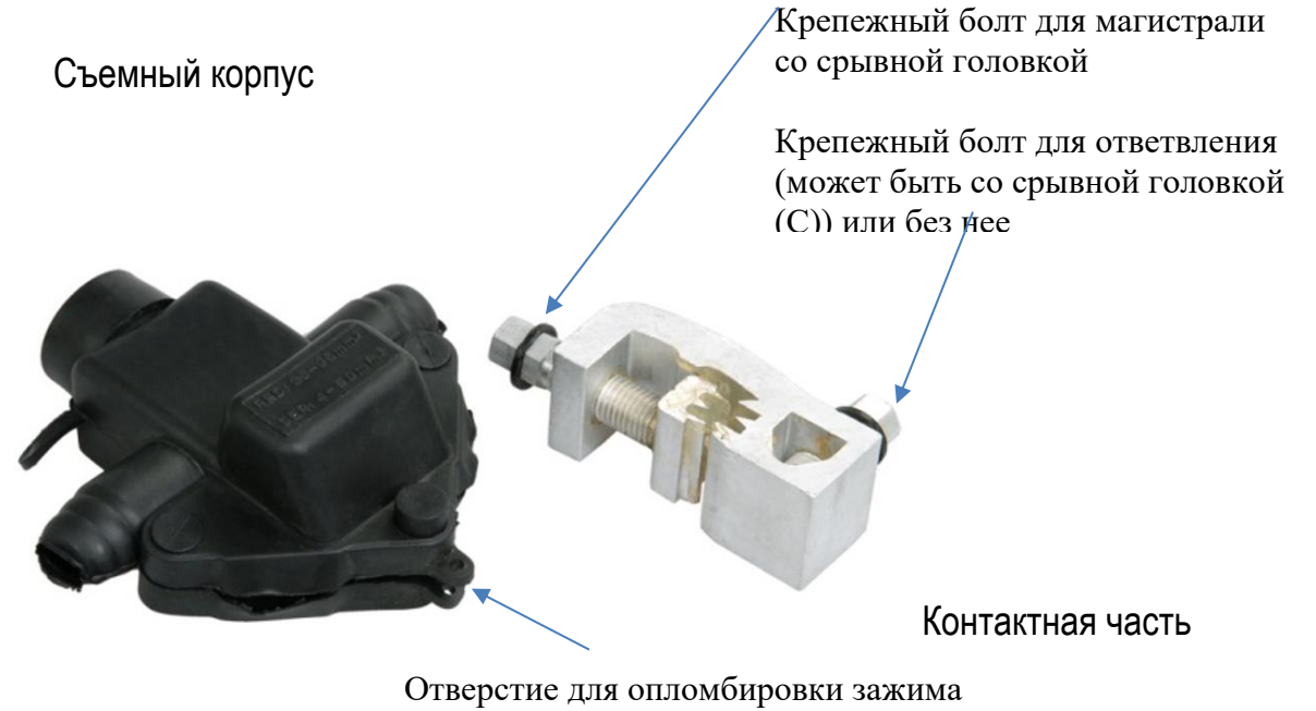
Рисунок 15 Зажим ответвительный с раздельной затяжкой болтов 30P3Б
