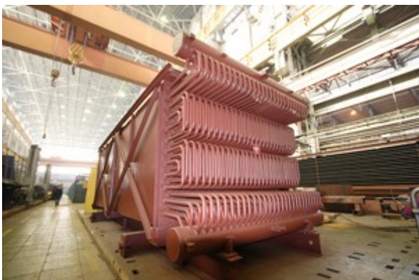
Модуль котла-утилизатора (фото ГК «РЭМКО»)
