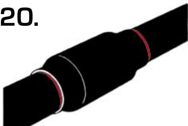
20. Установка кожуха CSC № 3
