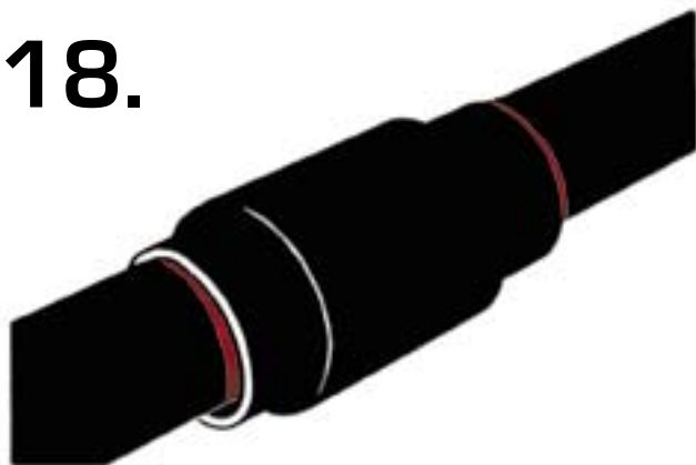
18. Установка кожуха CSC № 1
