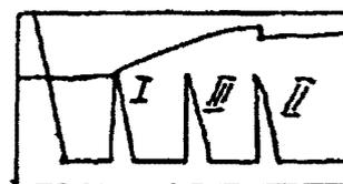
7.1. Установить ПЭП в положение максимума амплитуды эхо-сигнала от "ближнего" отражателя (I).
